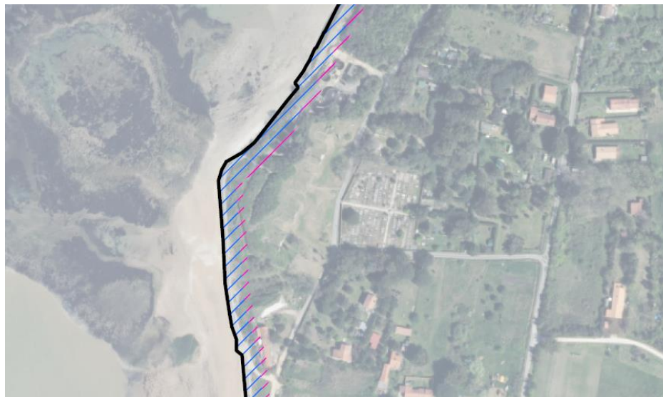
Carte n° 8 : projection du trait de côte à 2050 sur le secteur de Jamblet (Île-d'Aix), lié à l'érosion annuelle (en bleu) et à un évènement majeur (en rouge)
