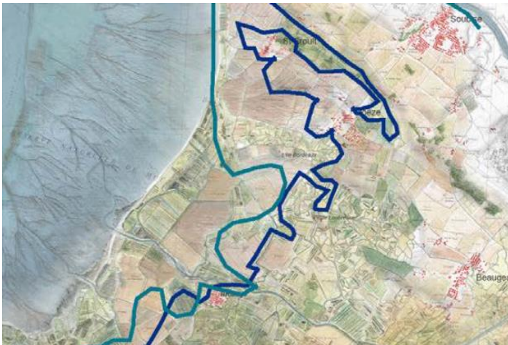
Carte n° 7 : limites des zones submergées dans le marais de Moëze suite aux brèches causées par l'érosion marine lors des tempêtes Martin (bleu foncé) et Xynthia (bleu clair)
